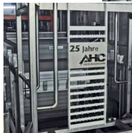
Kunststoffgestelle und -haken reduzieren den Nickelverbrauch.
