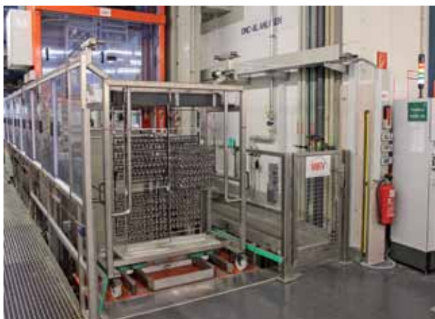
Die großen Gehänge zeigen, dass die neue Anlage über ein üppiges Warenfenster verfügt.
